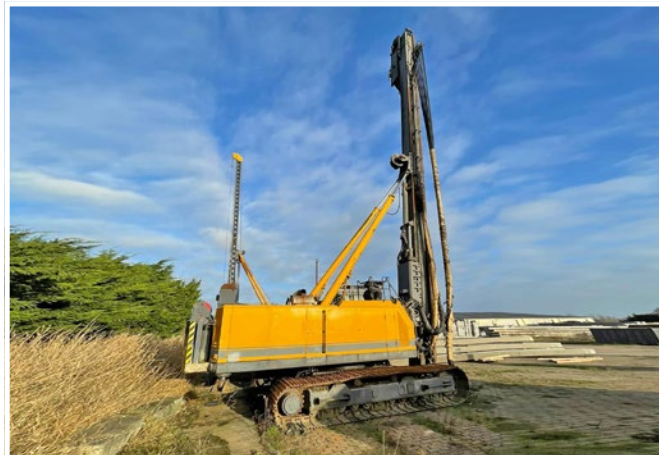
JUNTTAN PM18 PILE HAMMER
